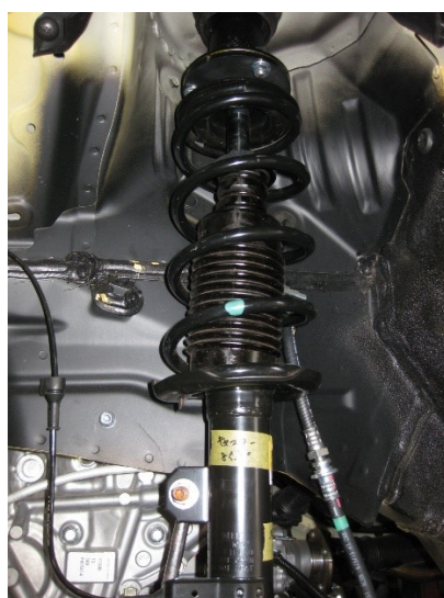
4インチアダプター取付後の純正ショック装着状態
