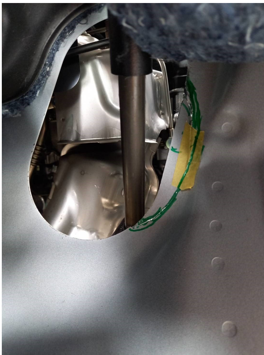
コラムカバーを外した後のカットライン目安
