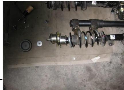
ストラットにアダプターの半部分を付属のナットで装着後にアダプターの凹み溝を合わせて3本ネジでしっかり締めます。
