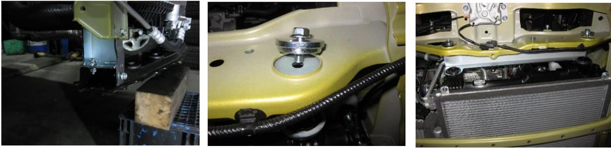
※フロントメンバーの固定ですが、前側のブロック部分はフレームと水平になるように角度を合わせます。
