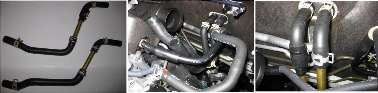
エアコンパイプは、ボディに干渉しないようにパイプを養生するなど、工夫してください。
