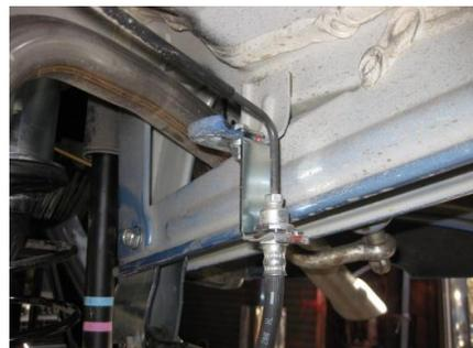
35. リアセンサースイッチ(レベライザー)の延長ステー取付(自動ライト調光付車のみ)
