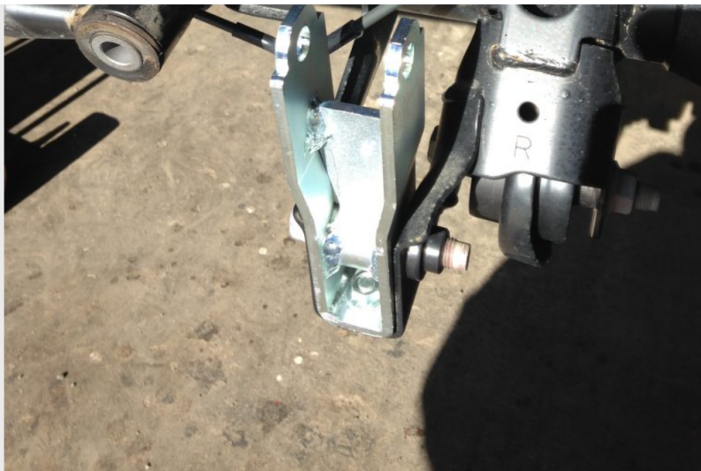
33.ラテラルステー組付け。
