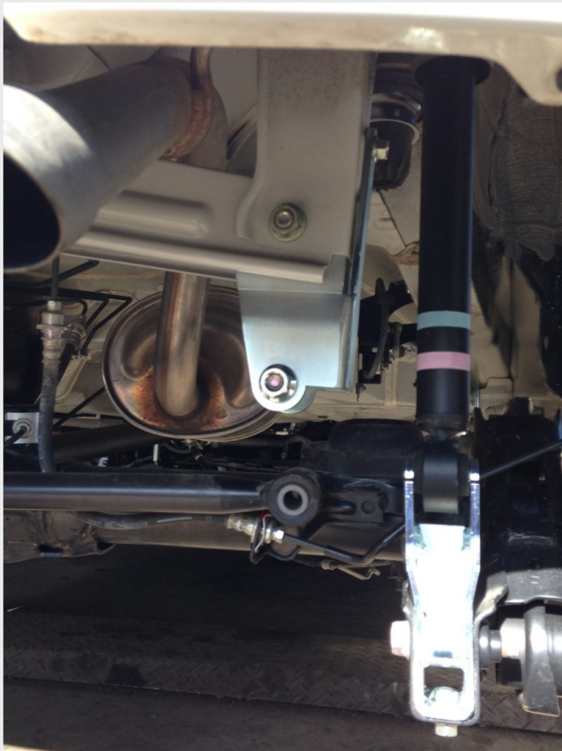
34.ブレーキ純正配管を付属のステーを写真を参考に取付してください。 赤丸のゴムを、ホーシング側にずらしてください。
