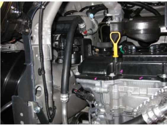
エアコンパイプの曲げ加工例
